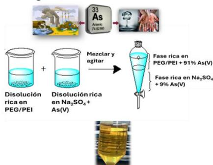
Figura 1. Representación de la formación de los ATPS PEG/PEI y  $\text{Na}_2\text{SO}_4$  para la extracción de As(V).
